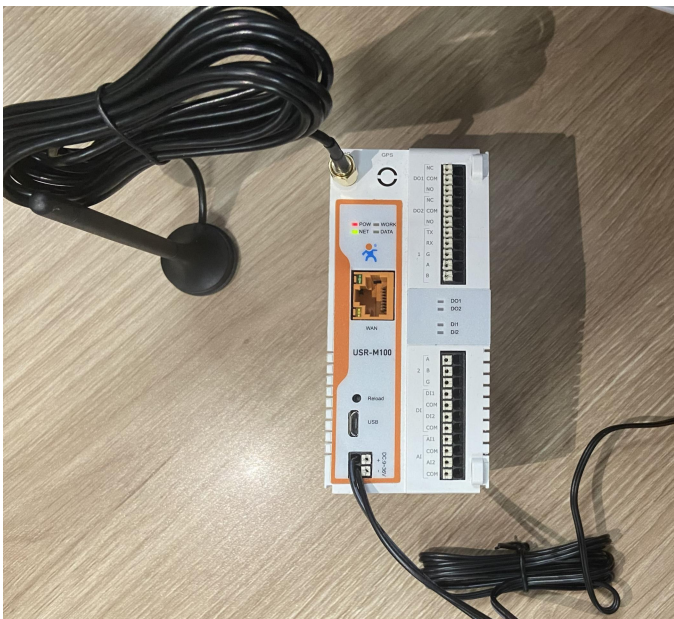
(1) 【网关上电】设备通电并连接 4G 天线
